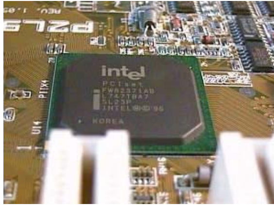
Figura 23 - Um dos integrantes do chipset i440LX
