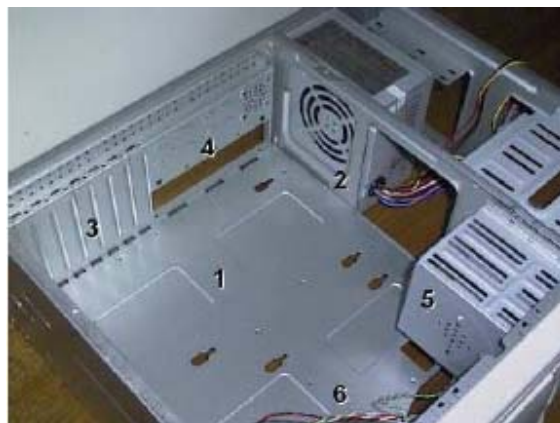
Fig. 9 - Interior de Um Gabinete Torre ATX
