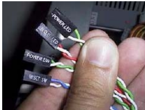
Fig. 19 – Conectores Para o Painel Frontal do Gabinete ATX O Conector Power SW é Ligado na Placa Mãe
