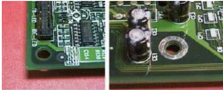
Fig. 13 – Furos da Placa de CPU (Placa Mãe)
