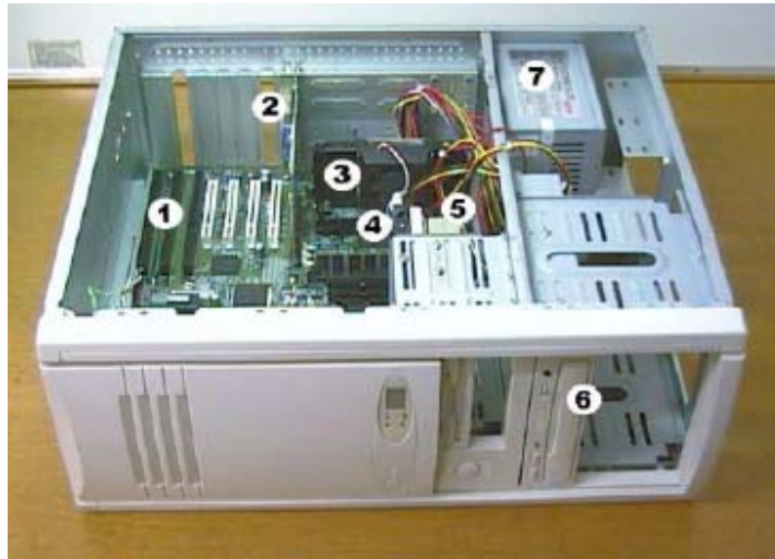
Fig. 15 - Disposição dos Componentes no Gabinete ATX 1) Placa de CPU - 2) Placa de Vídeo - 3) Processador - 4) Disco Rígido 5) Driver de Disquetes de 3½" - 6) Driver de CD-ROM - 7) Fonte de Alimentação
